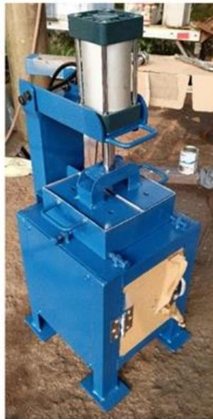
**Gambar 7.** Mesin cetak *eco paving block*.
