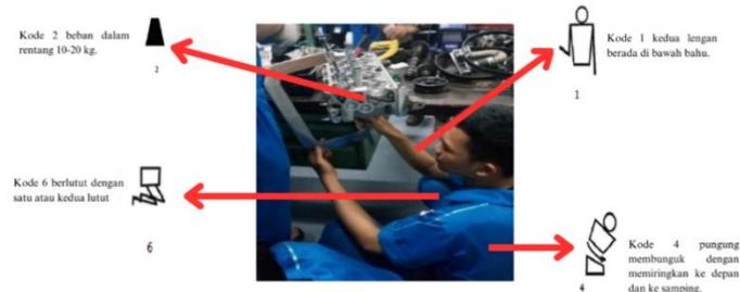
**Gambar 13.** Kode sikap teknisi saat proses pelepasan dan pemasangan katup mesin.
