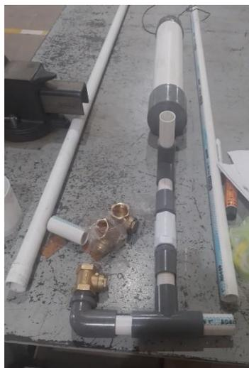
**Gambar 4.** Pipa PVC siap untuk dirakit.
