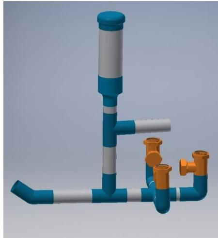
**Gambar 3.** Desain pompa hidraulik ram.
