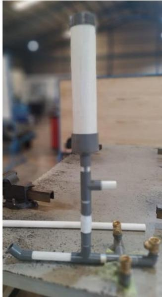
**Gambar 5.** Pompa hidram.
