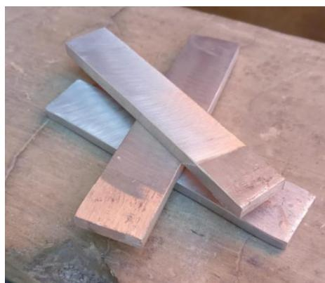
**Gambar 2.** Spesimen untuk anodizing.
