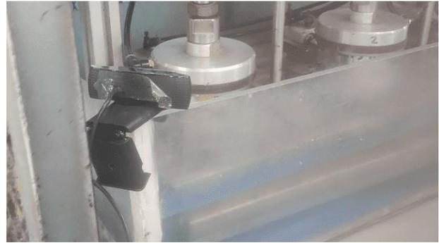
Gambar 12. *Camera* yang dipasang pada Mesin *Leak Tester*
