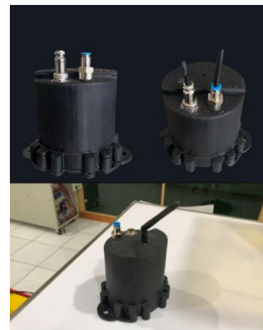
Gambar 11. Hasil Assembly Perangkat Keras Data Logger
