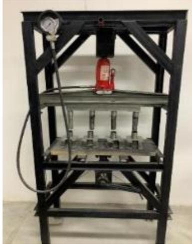
**Gambar 1.** Alat pres hidrolik manual.
