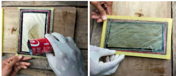
Gambar 8. Pembuatan komposit metode hand-lay-up
