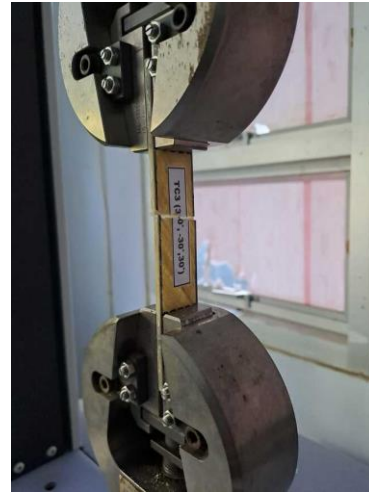
Gambar 12. Skema pengujian tarik
