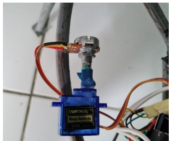
Gambar 13. Modifikasi Motor Servo SG90 Dengan Potensiometer
