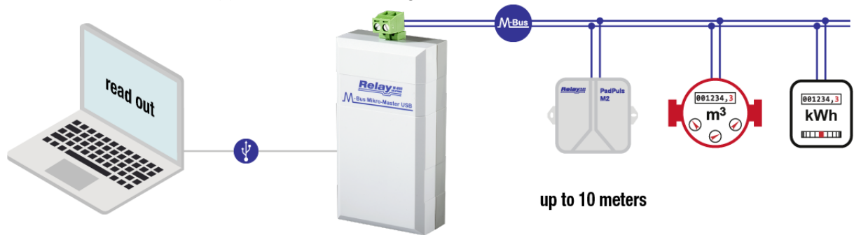
Gambar 3. Skematik Diagram Sistem M-Bus Data Logger
