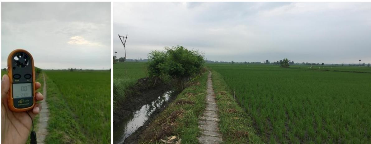
Gambar 3. Pengukuran kecepatan angin menggunakan anemometer di Desa Siman - Lamongan
