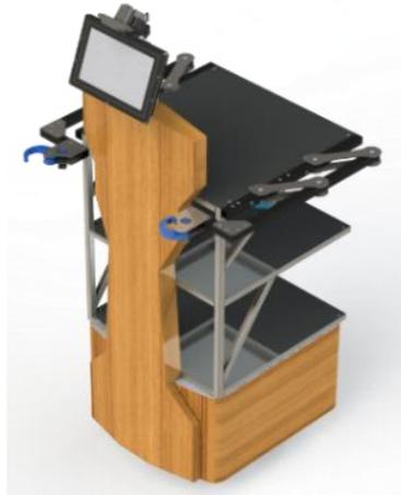
**Gambar 7.** Mekanisme pembuka pintu saat dipasang pada robot.
