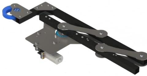
**Gambar 4.** Desain mekanisme pembuka pintu.
