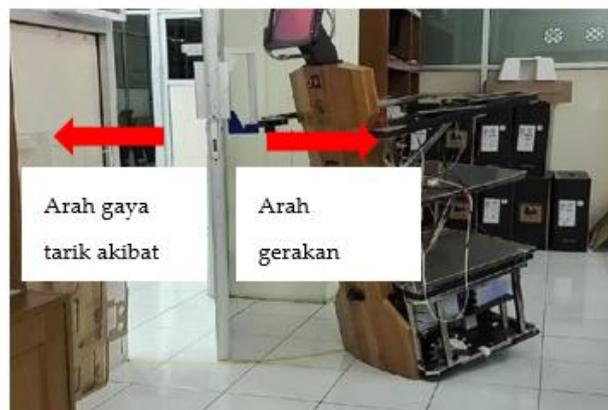
**Gambar 14.** Kondisi robot yang mengakibatkan proses membuka pintu tidak lancar.
