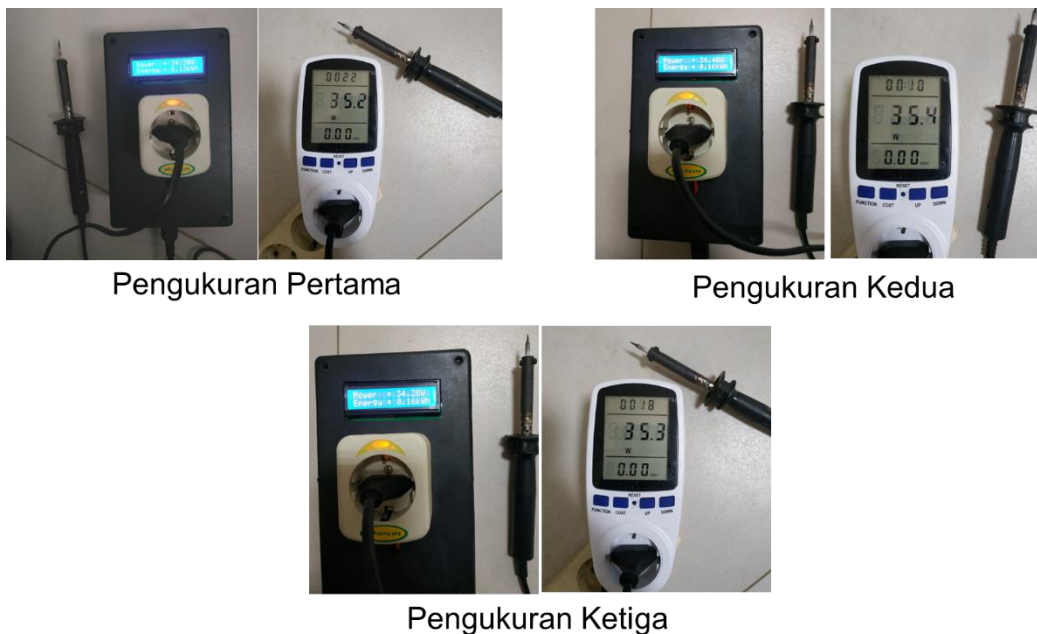
Gambar 5. Pengukuran daya listrik solder sebanyak tiga kali percobaan dengan menggunakan (a) wattmeter yang dirancang (hitam) dan (b) wattmeter komersil (putih)
