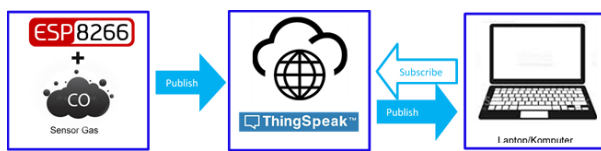
Gambar 4. Infrastruktur IoT monitoring penyerapan gas CO menggunakan Sansevieria sp
