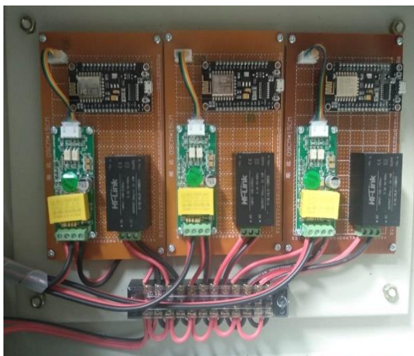
Gambar 8. Implementasi Rangkaian Perangkat Keras RTU
