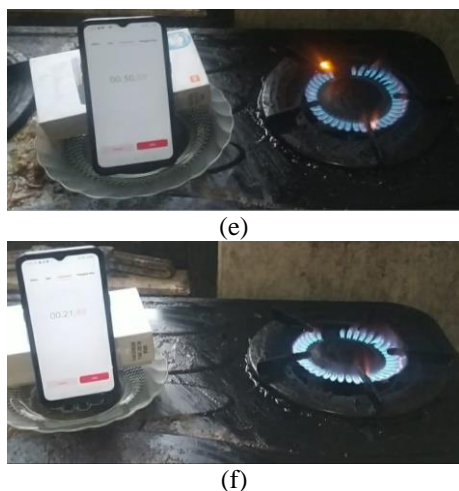
Gambar 6. Lama Nyala Api Biogas, (a) Variasi Campuran S1, (b) Variasi Campuran S2, (c) Variasi Campuran S3, (d) Perbandingan Lama Nyala Api LPG pada Biogas Variasi S1, (e) Perbandingan Lama Nyala Api LPG pada Biogas Variasi S2, (f) Perbandingan Lama Nyala Api LPG pada Biogas Variasi S3
