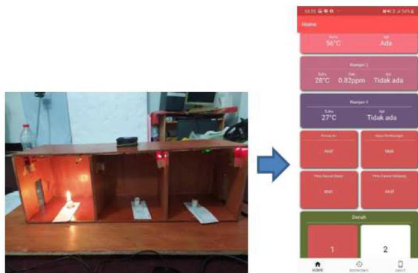
Gambar 10. Pengujian integrasi, respon aktuator bila ruangan 1 diberi gangguan
