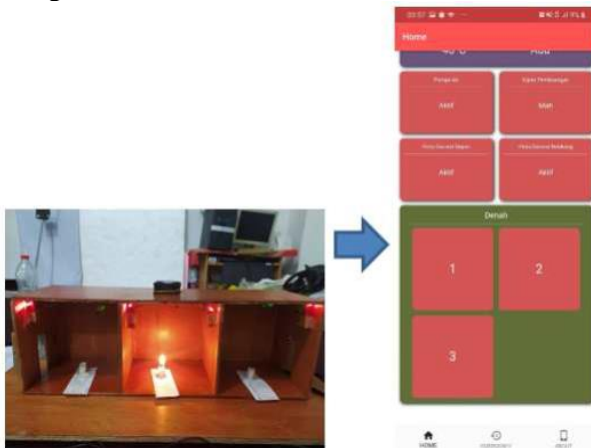
Gambar 12. Pengujian integrasi, respon aktuator bila ruangan 2 diberi gangguan
