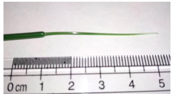
Gambar 10. Bentuk patahan uji tarik filamen UHMWPE
