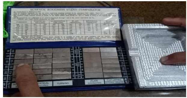
Gambar 18. Pengujian kekasaran permukaan posisi Middle
