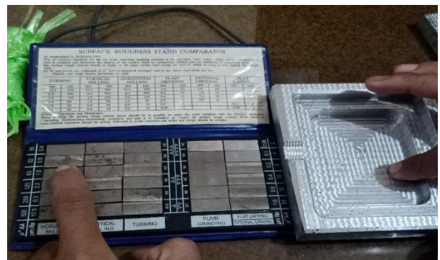
Gambar 19. Pengujian kekasaran permukaan posisi Bottom
