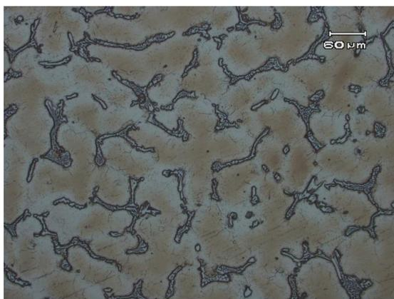
Gambar 18. Penampang potong pada sampel uji Y-blok dengan deoksidasi 0,2 % Al, Austenite 71%, Karbida krom 29%
