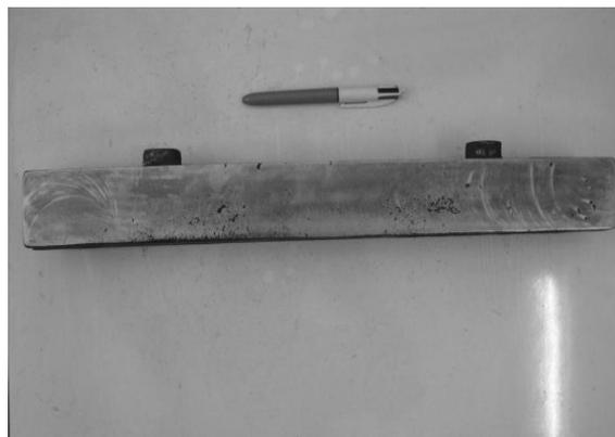
Gambar 14. Penampang potong pada Prototip “replaceable lip” dengan deoksidasi 0,3 % Al
