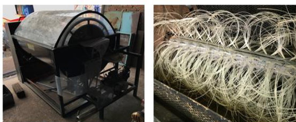
Gambar 6. Mesin pencuci umbi porang
